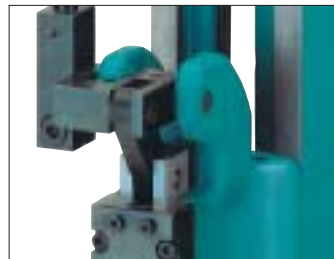
Umgesteckter ERGOPRESS® Handhebel für Bedienung durch Linkshänder
